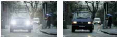
ダイナミックOFF時の映像 ダイナミックON時の映像 D-WDR機能により、自動車のヘッドライト、太陽光、蛍光灯等による光のハレーションを抑え、見やすい映像に補正します。
