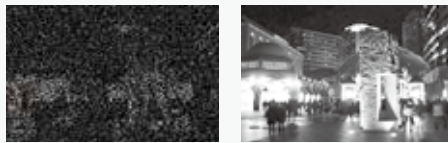
AGCと電子感度アップ機能との組み合わせにより、低照度の環境下でも鮮明な画像の撮影ができます。
