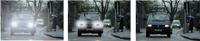
ダイナミックOFF時の映像 イクリプスON時の映像 ダイナミックON時の映像 ワイドダイナミック機能とイクリプス機能により、自動車のヘッドライト、太陽光、蛍光灯等による光のハレーションを抑え、見やすい映像に補正します。
