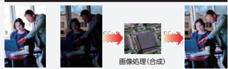
A:低速シャッター B:高速シャッター 画像処理(合成) 画像処理により最適な映像を出力します
